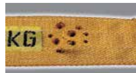
Повреждение в результате воздействия высокой температуры
