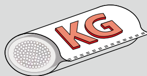
Маркировка грузоподъемности вплетена в чехол
