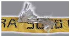
Повреждение внутренних прядей
